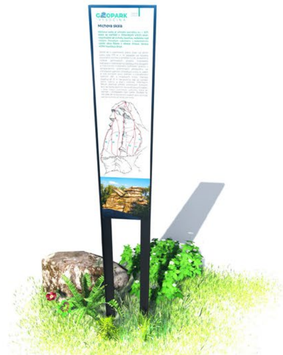
Vertikální volně stojící infopanel Jednoduchý rám z ocelového T profilu (60x60), žárový zinek + komaxit. Kotvení betonováním nebo na zemní vruty.
