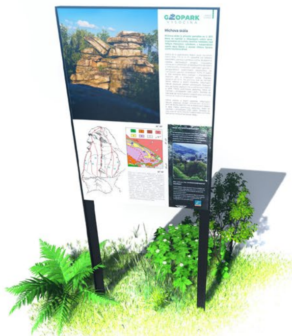
Vertikální volně stojící infopanel Jednoduchý rám z ocelového T profilu (60x60), žárový zinek + komaxit. Kotvení betonováním nebo na zemní vruty.
